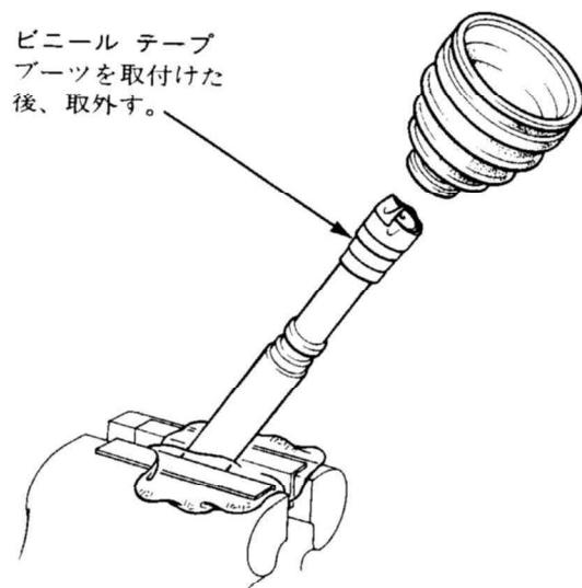
②ベアリング レースとドライブ シャフトのマークを合わせ、レースを取付ける。
